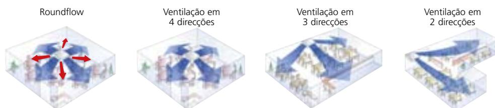
O caudal circular radial de 360° permite uma distribuição uniforme do caudal de ar
